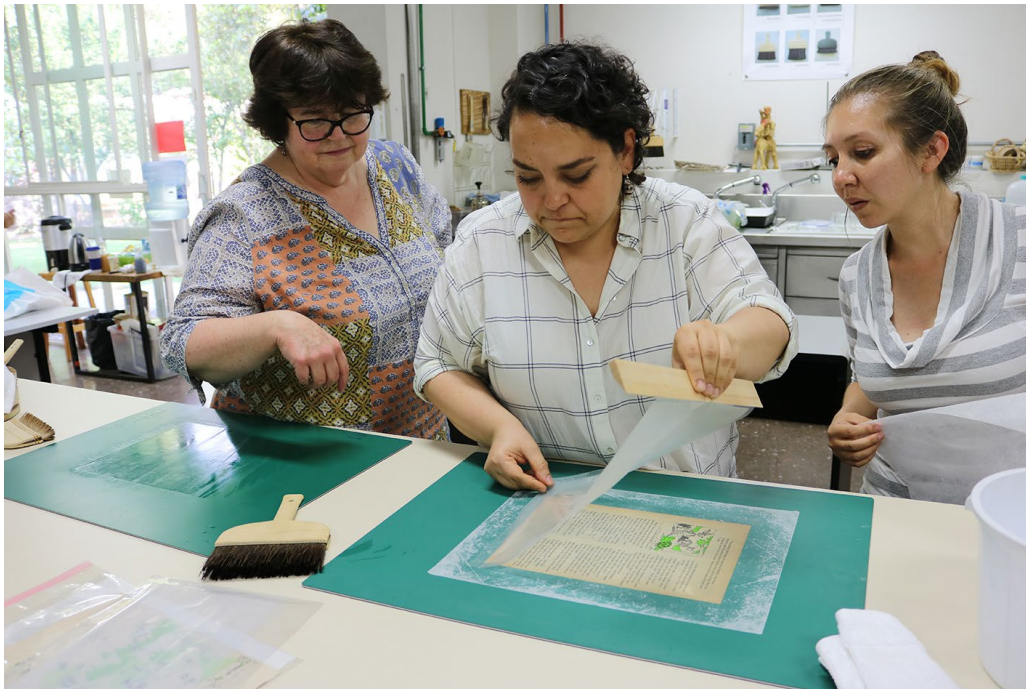
Figura 4. Práctica de laminado en la etapa latina, emisión del curso 2018. Imagen: Taller de Documentos Gráficos, ©CNCPC-INAH, 2018.
