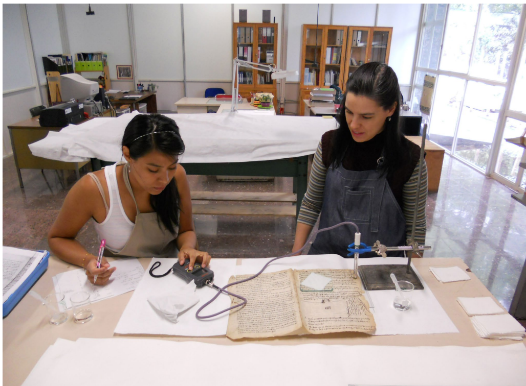
Figura 10. Medición de pH con potenciómetro de obra proveniente de San Nicolás Coatepec. Imagen: Archivo del Taller de Documentos Gráficos, ©CNCPC-INAH, 2012.
