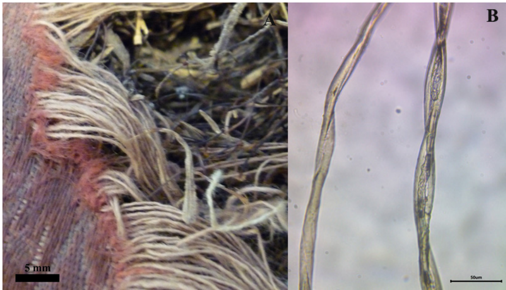
Figura 7. Fibras del tapiz de Gossypium (algodón). A) Fibras de color blanco opaco y textura suave, expuestas por la rasgadura del mismo. B) Fibras de lumen amplio, deprimidas, y de paredes gruesas, los filamentos se tuercen a lo largo en estructuras llamadas convoluciones. c=convoluciones. Imágenes: ©Ana Laura Avelar-Carmona, 2022.
