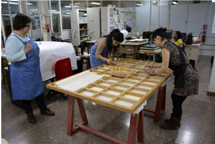
Figura 12. Construcción de un karibari para proceso de secado por tensión, dirigido por Tania Estrada y Patricia de la Garza después de sus estancias profesionales en el TNRICP. Imagen: Archivo del Taller de Documentos Gráficos, ©CNCPC-INAH, 2014.
