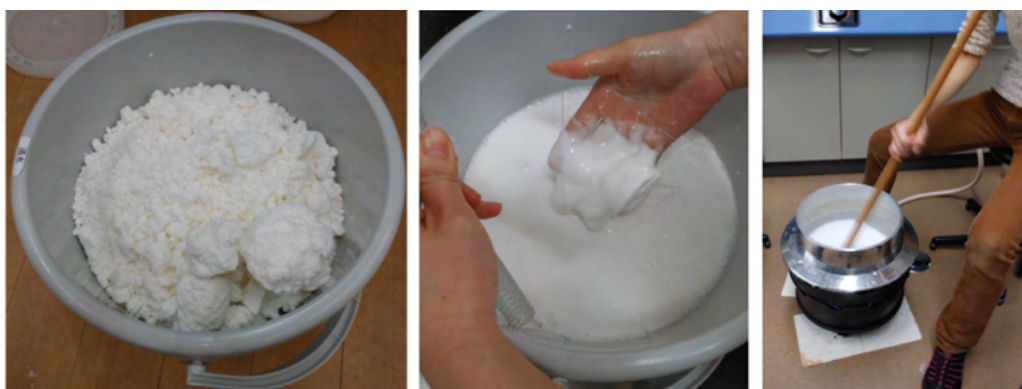
Figura 3. Almidón shōfu sin remojar, almidón shōfu remojado en agua desionizada y estufa especial donde se cocinaba el almidón. Imágenes: ©Tania Estrada Valadez, 2014.
