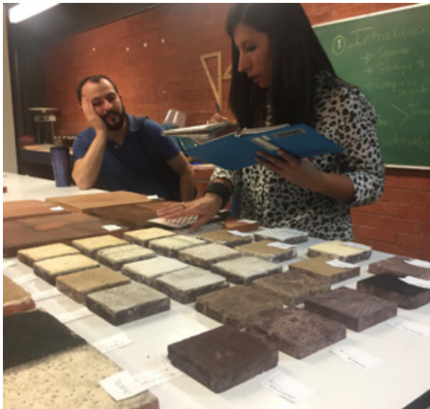
▲ Figura 6. Registro de cambio de color con Tabla Munsell. Foto: Marlene Sámano Chong. ©INAH
