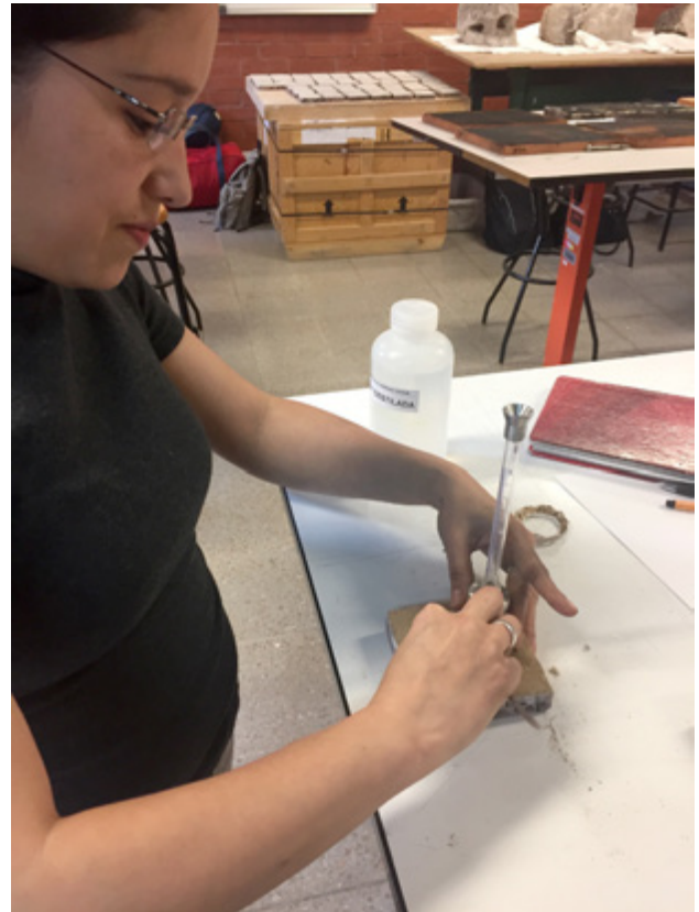
▲ Figura 7. Medición de cambios de permeabilidad con tubo de Karsten. Foto: Lilian García-Alonso Alba. ©INAH
