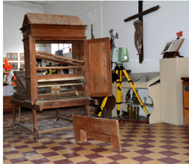
▲ Figura 3. Levantamiento de órgano con escáner láser modelo P20 Leica®. | Foto: © Acervo CNCPC-INAH, 2016.
