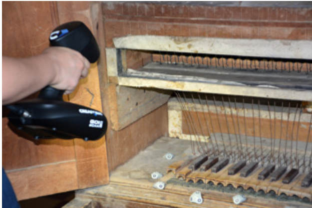
▲ Figura 5. Levantamiento de teclado con escáner de luz estructurada modelo Goj Scan3D Creaform®. | Foto: © Acervo CNCPC-INAH, 2016.
