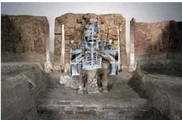
▲ Figura 9. Radiografías que muestran el poste colocado en la intervención de 1974, por la densidad de los materiales es posible observar la presencia de las resinas y el tubo de PVC que protegen al poste de acero inoxidable (Esteban Azueta, Armando Guerrero, Alejandro Taylor y Delio Cruz) | © INAH, 2014.
