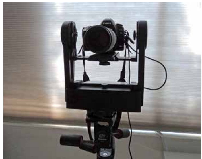
▲ Cámara reflex con la montura para gigapixel | © Fototeca CNCPC-INAH, 2014
