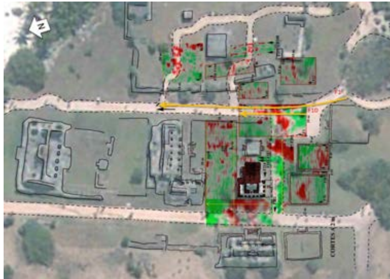
Figura 9. Vista de los cortes de profundidad a 2 m efectuados con la antena de 400 MHz en el perímetro del Edificio 16. Las zonas en color rojo, representan las secciones donde se detectaron cavidades por la disolución de la roca caliza. Imagen: Jorge Blancas, 2015, ©CNCPC-INAH.
