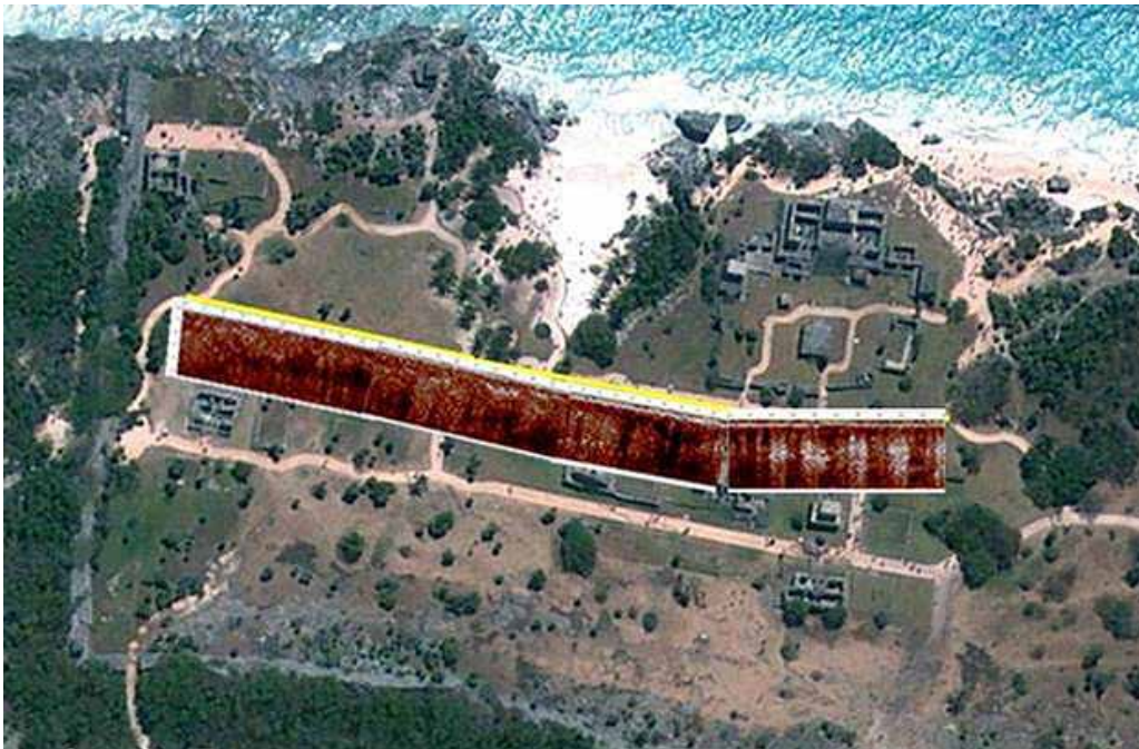
Figura 7. Acercamiento de la imagen satelital tomada de Google Earth® con la ubicación de una de las líneas de georradar con antena de 200 MHz obtenidas en el andador central del sitio. Se observan claramente las reflexiones en blanco en la parte sur del radargrama (derecha de la imagen). Imagen: Jorge Blancas, 2015, ©CNCPC-INAH.
