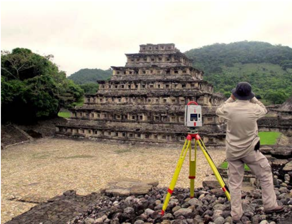
Figura 5. Proceso del registro de la Pirámide de los Nichos a partir del uso de escáner 3D. Imagen: ©CNCPC-INAH, 2014.
