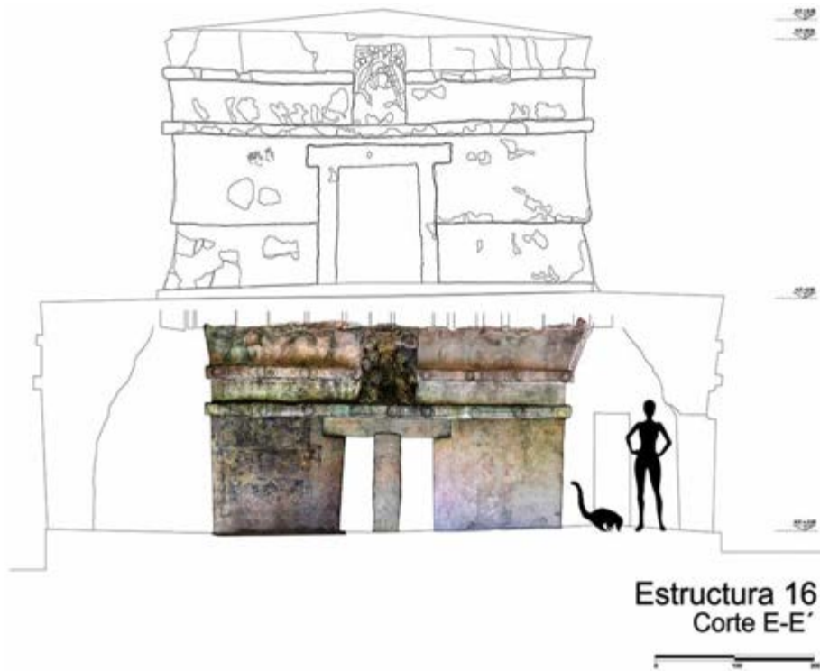
Figura 17. Foto-mosaico insertado en el levantamiento correspondiente en AutoCAD®. Fachada oeste del santuario interior del Edificio 16 de Tulum (en proceso). Imagen: Víctor Gabriel Severiano Flores, ©CNCPC-INAH, 2017.
