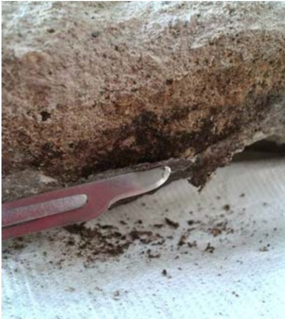
Figura 9. Limpieza mecánica en la que se eliminó el polímero del reverso de la lápida. Imagen: Mariana Díaz de León Lastras, 2015, ©CNCPC-INAH.
