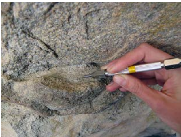
Figura 6. Prueba in situ para medir la dureza en pastas de resane. Sitio El Vallecito, Baja California. Imagen: Mariana Contreras del Cueto, 2014, ©CNCPC-INAH.
