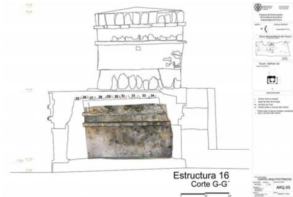
Figura 16. Foto-mosaico insertado en el levantamiento correspondiente en AutoCAD®. Fachada sur del santuario interior del Edificio 16 de Tulum. Imagen: Víctor Gabriel Severiano Flores, ©CNCPC-INAH, 2016.
