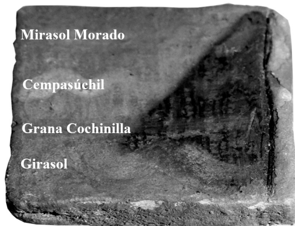
Foto 5. Muestra de reducción. Placa en barro con pigmentos orgánicos. Fuente: Mónica Sosa, 2022.
