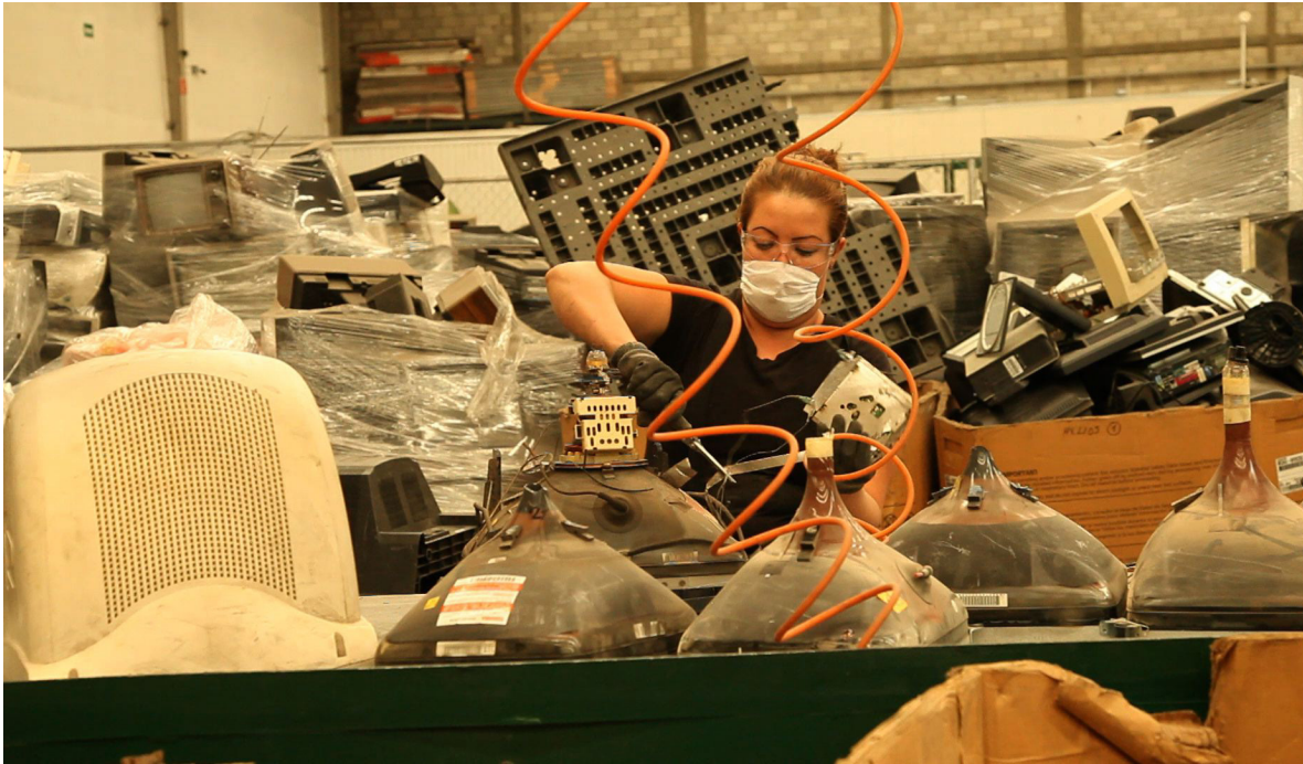
Otro monitor es desarmado en una planta de reciclaje en Querétaro. Los cinescopios esperan el siguiente proceso: serán convertidos en material para fabricar pisos. Foto © Hugo Chávez Carvajal.
