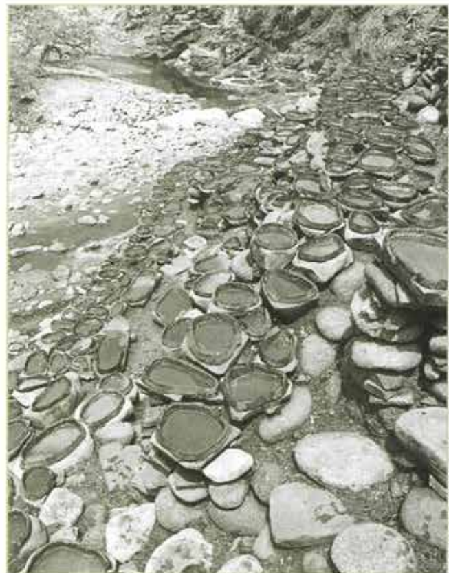
Victor Osorio. Pochecitos para la evaporación de agua salada. Salina de San Francisco, Tejupilco, Estado de México, 2007.
