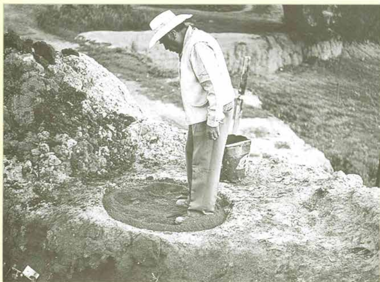
Figura 9. Jeffrey R. Parsons. Apesomando la mezcla de tierras dentro de la pila , taller de Sebastián Nopalitla, Nexquipayac, 1987.
