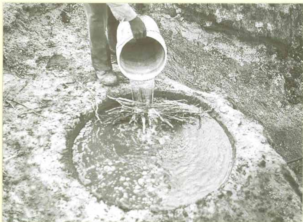
Figura 10. Jeffrey R. Parsons. Vertiendo agua limpia sobre la pila con ramas para amortiguar la caída , taller de Sebastián Nopalitla, Nexquipayac, 1987.
