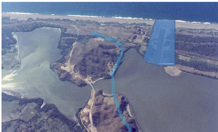
**Imagen 4.** En la imagen la franja azul gruesa señala la ampliación del canal a efecto de dejar pasar los buques que descargan el gas; la línea delgada el trazo del desvío ferroviario. **Fuente:** Sobre Google Earth, modificado por ArqIgo. Román Chavez T., 2012.
