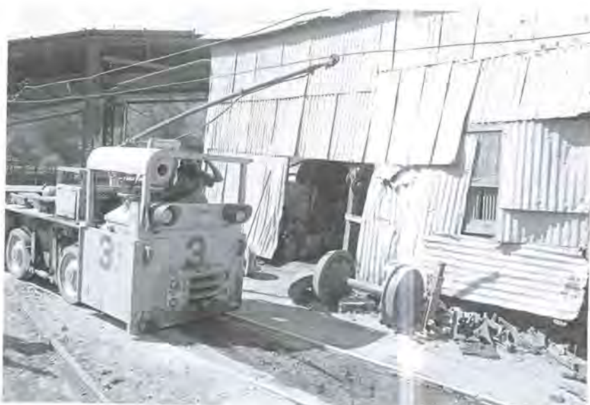
Carro eléctrico para arrastre de góndolas de la mina Cata, Guanajuato. Foto: David Maawad
