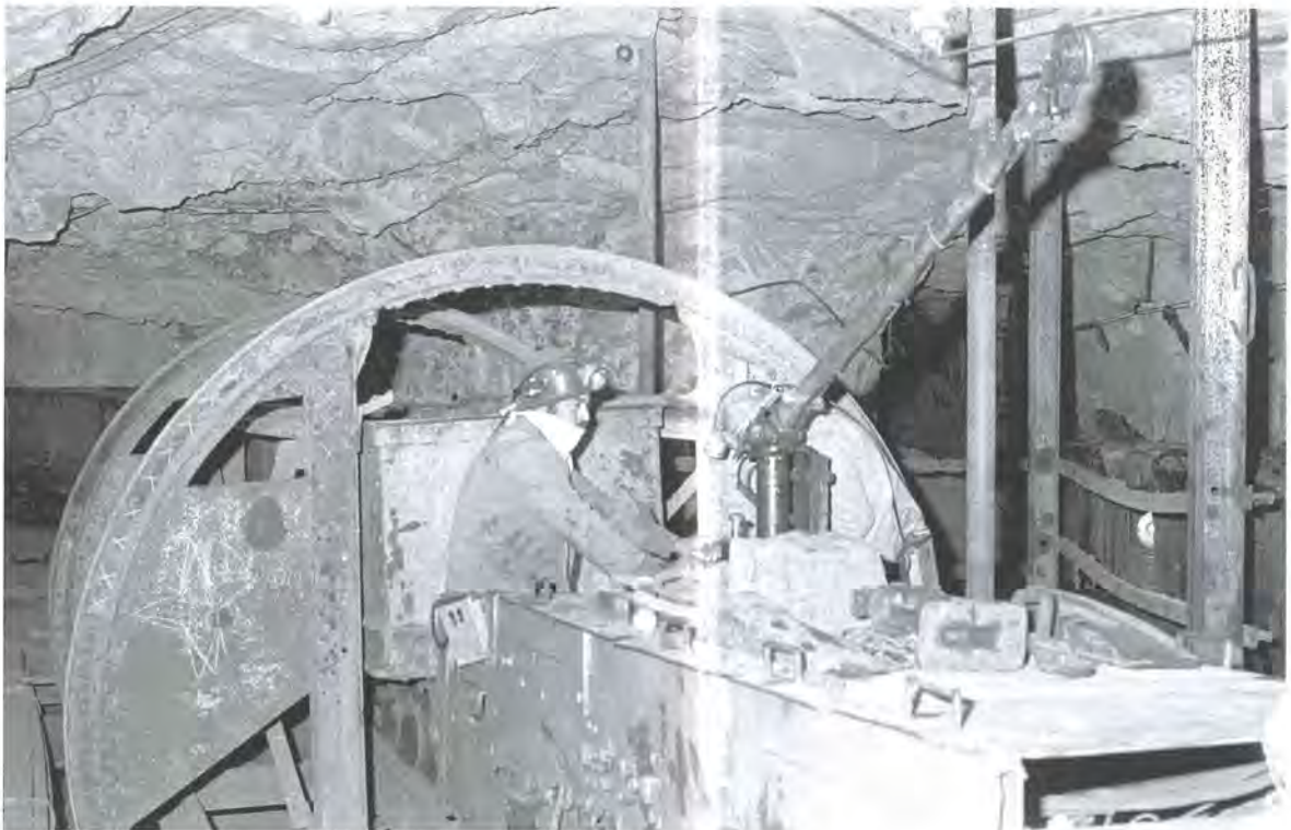
Motorista activando la “maroma” en la mina San Juan, Pachuca, Hidalgo. Foto: David Maawad
