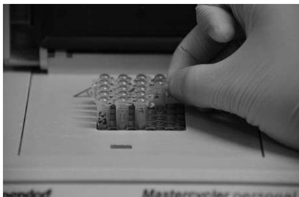
Figura 13. Colocación de los tubos en el termociclador. Cada uno contiene los componentes químicos y los extractos obtenidos de las muestras de hueso con que se llevará a cabo la reacción en cadena de la polimerasa (PCR).
