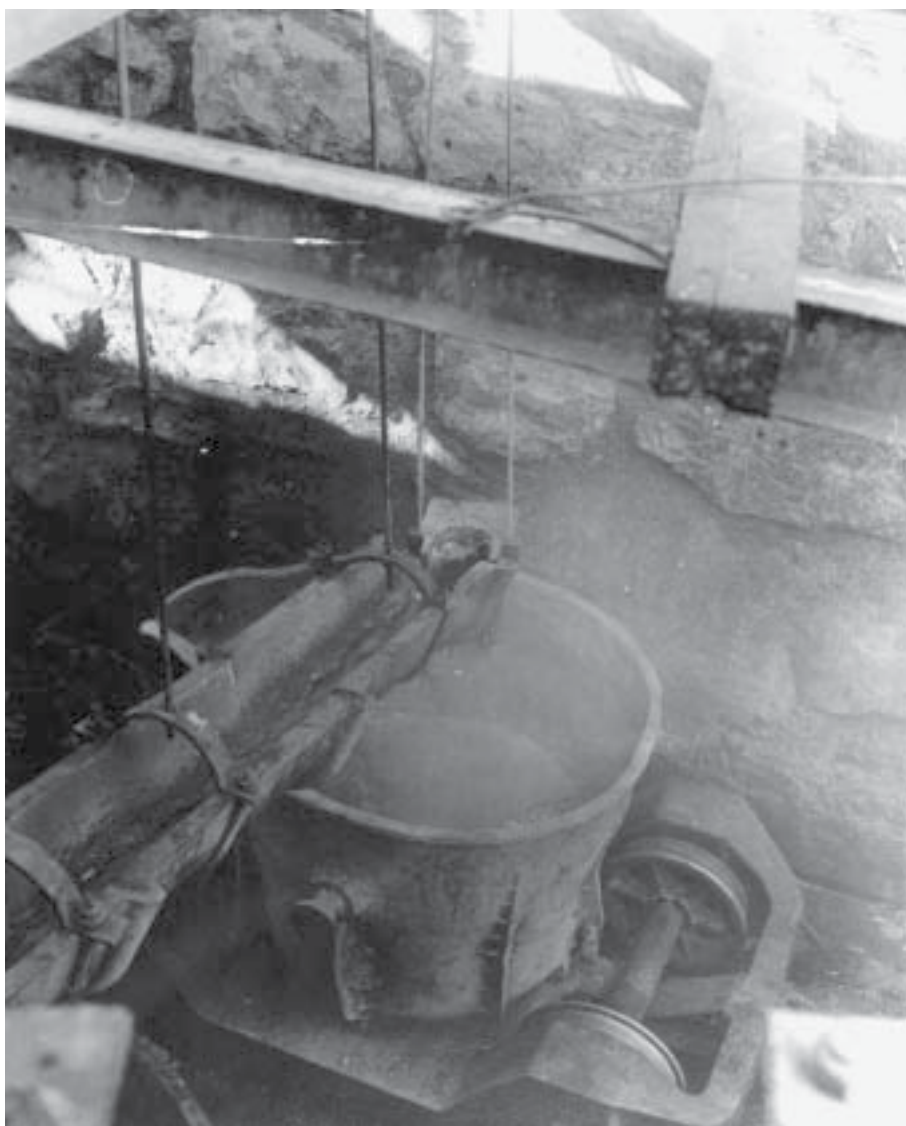
Olla para el transporte de metal fundido de los hornos y refinadoras en maniobras de la grúa eléctrica, 1908, Cananea, Sonora. ©Coordinación Nacional de Museos y Exposiciones.
