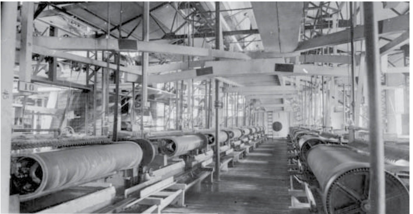
Mesas de hule para concentración de metales. La Concentradora no. 2. En esta sección empecé a trabajar el 22 de diciembre de 1910 como Ayudante de Mesero, 1908, Cananea ©Coordinación Nacional de Museos y Exposiciones.
