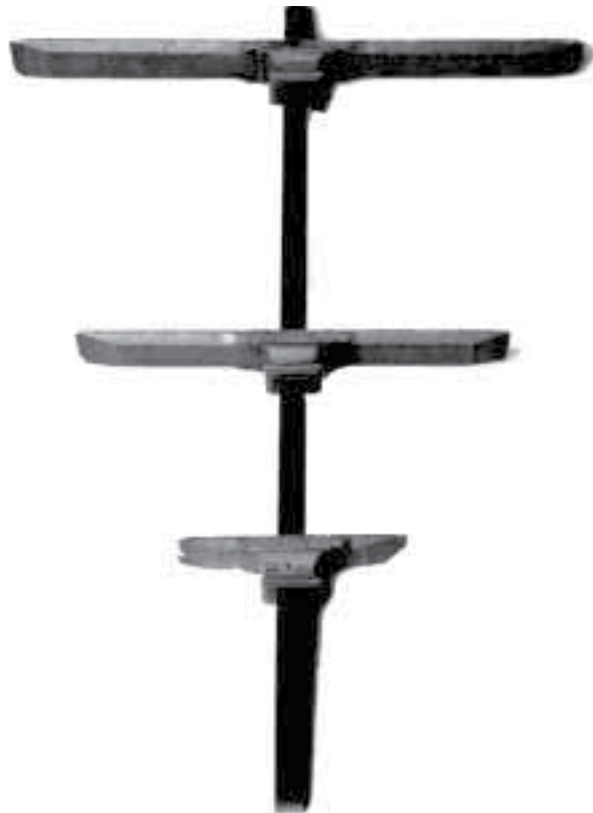
Ballestilla. Instrumento para medir alturas de astros y distancias celestes que se empezó a usar en la náutica en el siglo XVI. Museo Naval, Madrid. Inv. 289. © Carlos V. La náutica y la navegación.
