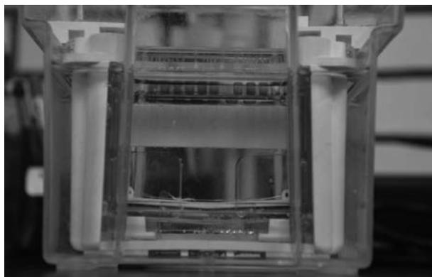
**Figura 14.** Los productos resultantes de la PCR se someten a electroforesis para corroborar si un determinado marcador genético amplificó, así como para comprobar que no existió contaminación en el proceso.
