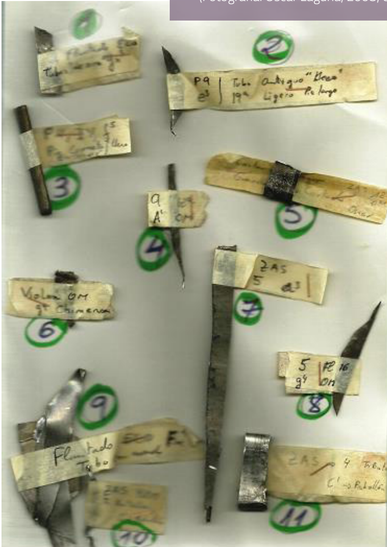
Figura 3. Muestras de metal de los tubos del órgano de la Seo de Zaragoza (Fotografía: Oscar Laguna, 2008; cortesía: Gerhard Grenzing, S. A., España).
