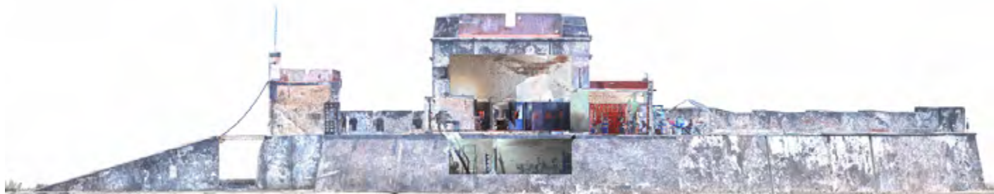
Figura 8. Sección del baluarte de Santiago, obtenido a partir del levantamiento arquitectónico con escáner laser, LIAD-CNMH, 2014.
