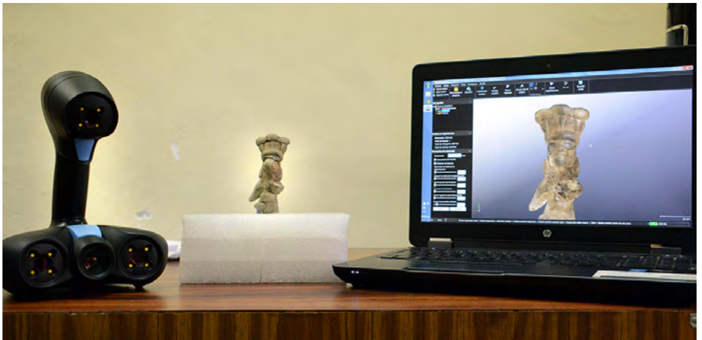
Figuras 9 y 10. Escáner Go!SCAN 20 y figurilla antropomorfa extraída del manantial de la Media Luna, S. L. P., INAH-CNMH (Fotografía: Cuauhtémoc Martínez Huerta).
