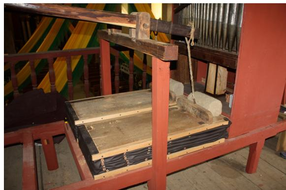
**Tirante:** es el elemento que une al fuelle con la palanca y permite la elevación del tablero superior cuando se acciona la palanca.
