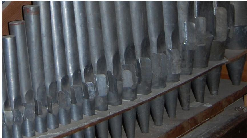
**Alma.** Es una lámina gruesa de metal (estaño-plomo) colocada entre el pie y el cuerpo, a la altura del borde superior del labio inferior; el borde del alma que se localiza del lado de la boca es recto y chaflanado, dejando una pequeña abertura sin soldar para permitir el paso del aire, esta ranurita se puede conocer como grieta o luz del alma (figura 133).
