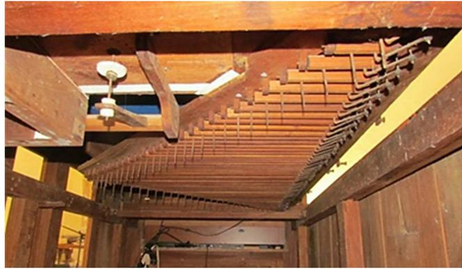
↗ **Figura 49.** Reducción horizontal. Izquierda: esquema de reducción horizontal (INAH, SEOHM, 2017). Derecha: reducción horizontal del órgano de la Catedral de Campeche, Campeche, México (INAH, SEOHM, 2016).
