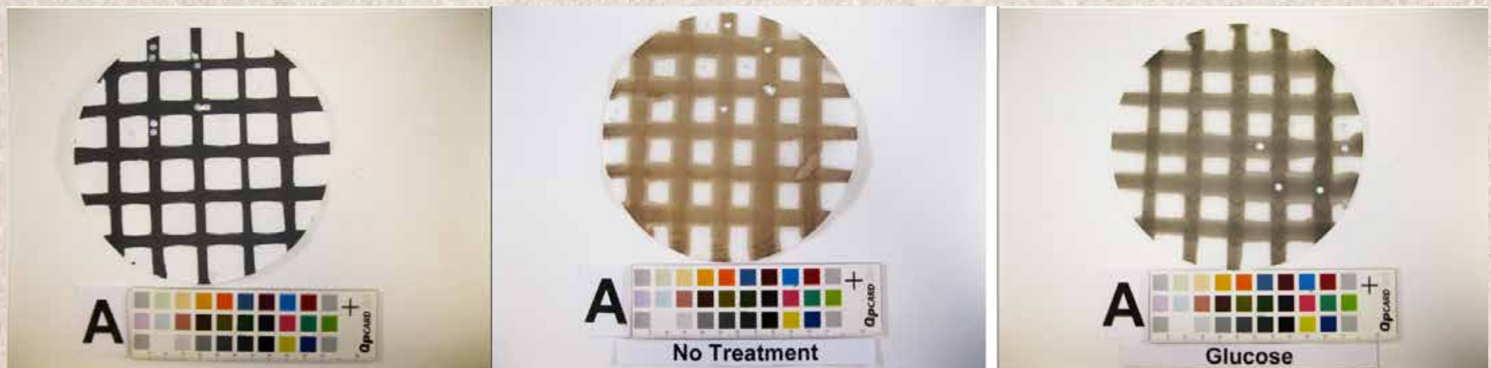
Figura 1. Ejemplo de una muestra preparada para evaluación del tratamiento, Nueva (izquierda); tras dos ciclos de envejecimiento, sin tratamiento (centro); tras dos ciclos de envejecimiento, tratada con disolución alcalina de alfa-D-Glucosa (derecha). Nota: los agujeros de las probetas revelan los lugares de toma de muestra para GPC. Fotografías tomadas por la autora.
