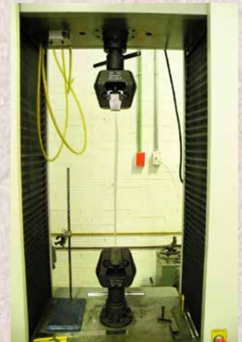
Figura 3. Pruebas de peeling probetas del sistema de laminado
