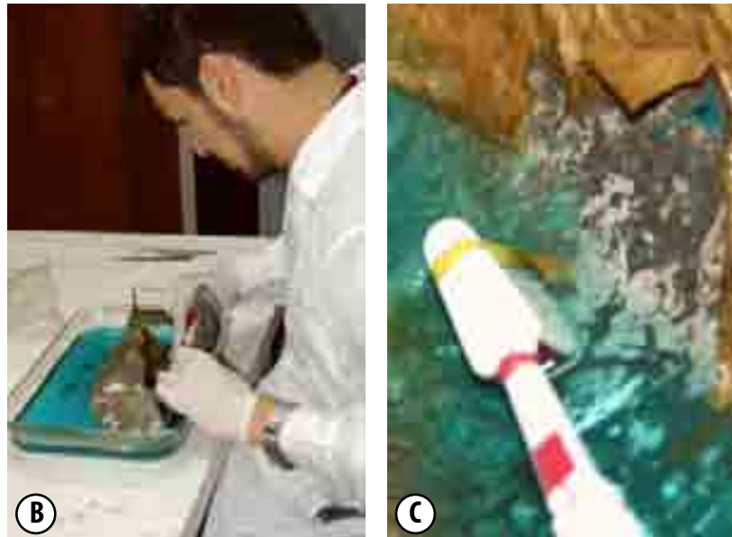
FIGURA 3. B) Inmersión en Tritiplex III. C) Eliminación de cloruros y sulfatos con cepillo. D) El M-6030 después de la inmersión.
