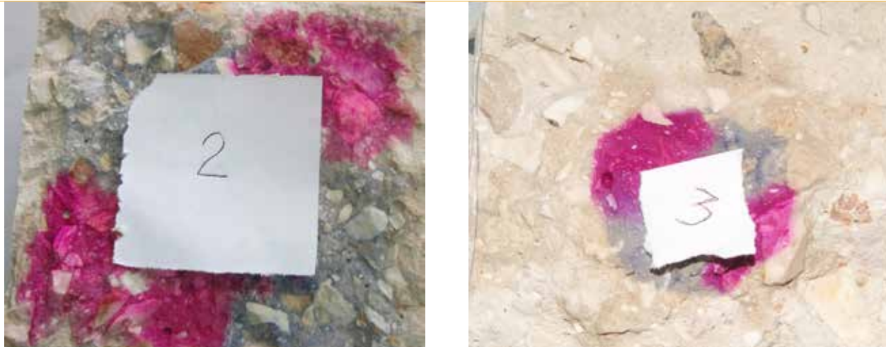
Figura 2 A.- Coloración de indicadores aplicados en concreto con poco avance de carbonatación. B.- Coloración de indicadores aplicados en concreto con un considerable avance de carbonatación.
