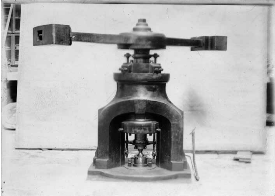
10. Prensa de volante. La prensa mostrada perteneció a la Casa de Moneda y es ejemplo de las que comenzaron a usarse en la Nueva España a principios del siglo XVIII, desplazando la ancestral tecnología basada en el golpe de martillo. El modelo que aparece en la foto fue desechado años después de tomarse esta imagen.
