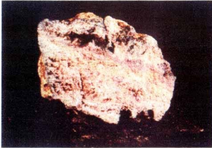
Foto 18. La muestra originalmente ofrecía poca resistencia a la fractura y presentaba pulverulencia, al ser consolidada se obtuvo firmeza y dureza en el material. La impregnación en rocas de estas características fue total.
