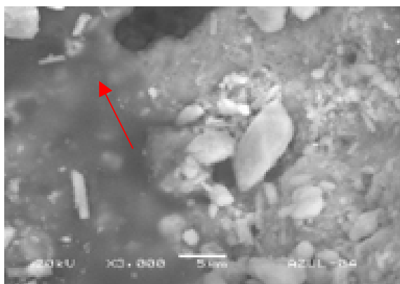
Figura 11. Micrografía que muestra una sustancia amorfa que envuelve y rodea a los cristales de calcita. MEB 3000 x. 20 kV.
