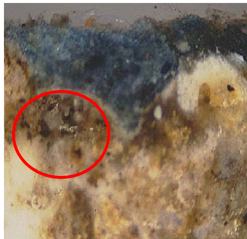
Corte estatigráfico de pintura mural sobre enlucido de cal, en donde el área oscura registró un alto contenido de azufre en el microanálisis elemental
