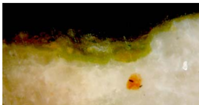
Figuras 43 y 44. Cortes transversales de pintura verde. Se observa una capa densa con cristales amarillos en el interior.
