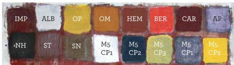
Figura 7. Apariencia de la probeta experimental una vez aplicadas la imprimación y las diferentes pinturas de pigmentos puros y mezclados utilizados en esta investigación: imprimación (IMP), albayalde (ALB), oropimente (OP), ocre de mina inglés (OM), hematita (HEM), bermellón (BER), carmín (CAR), azul de Prusia (AP), negro de humo (NH), siena tostada (ST), sombra natural (SN) y las diferentes capas pictóricas que emulan las muestras M5 (M5-CP1, M5-CP2 y M5-CP3) y M6 (M6-CP1 y M6-CP2)
