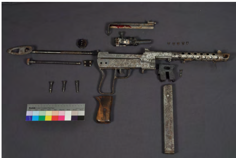
Figura 2. Estado de conservación del arma al inicio de la segunda intervención en el STRM. Fotografía: A. Castellanos, R. Ruiz y D.Vega, 2012
