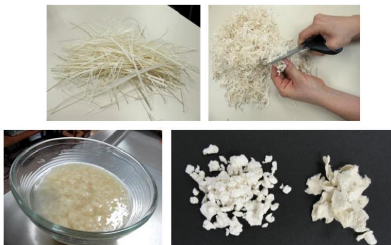
Figura 2. Proceso de elaboración de pulpas a partir de papel japonés y papel de algodón (J. Ponce y D.Terrazas. 2014).
