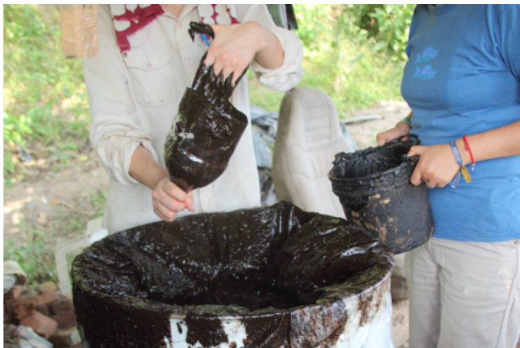
Figura 4. Producto comercial de emulsión asfáltica base agua (Impertop A de Comex), Annick Daneels, 2013.
