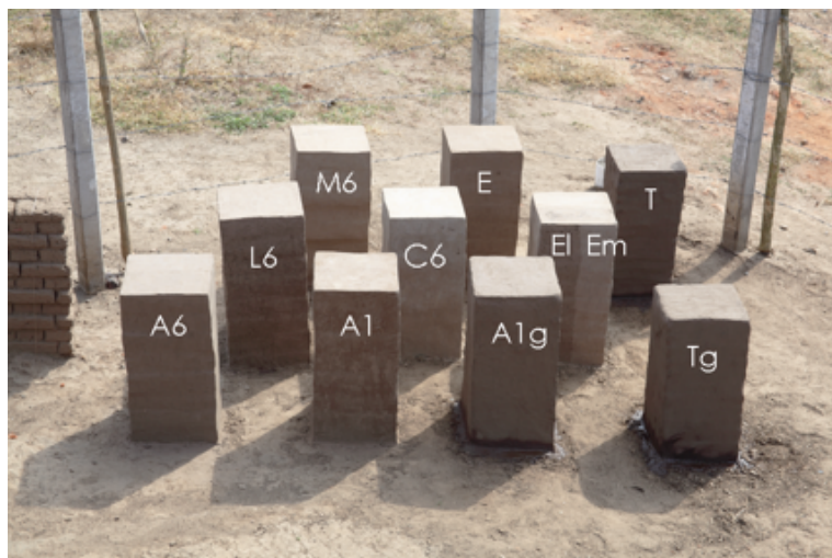
Figura 15. 10 muros de la 2ª serie de prueba de resistencia a la intemperie, Yuko Kita, 2014.
