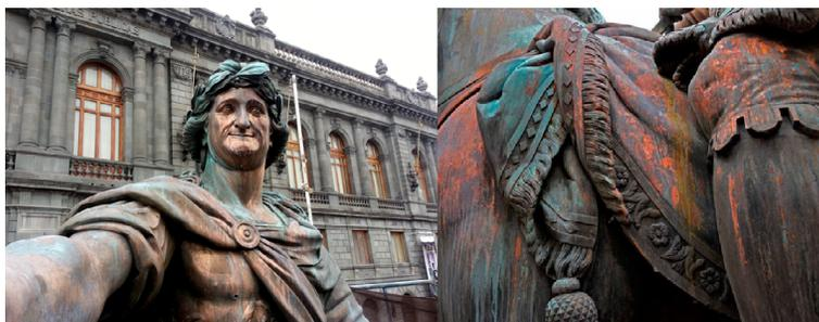
Figura 2. Las imágenes ilustran algunos de los daños causados por la fallida intervención: la pérdida de la capa superficial, desaleación y corrosión: productos de corrosión verdes, nitratos de cobre, debido a la acción del ácido nítrico. Cortesía de Gabriela Peñuelas y Ricardo Castro, INAH.
