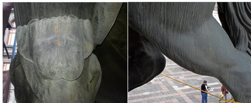
Figura 5. Zonas no intervenidas y prácticamente no dañadas donde se muestra la capa de corrosión / pátina de la escultura, hollín y los típicos escurrimientos de lluvia. Cortesía de Gabriela Peñuelas y Ricardo Castro, INAH.
