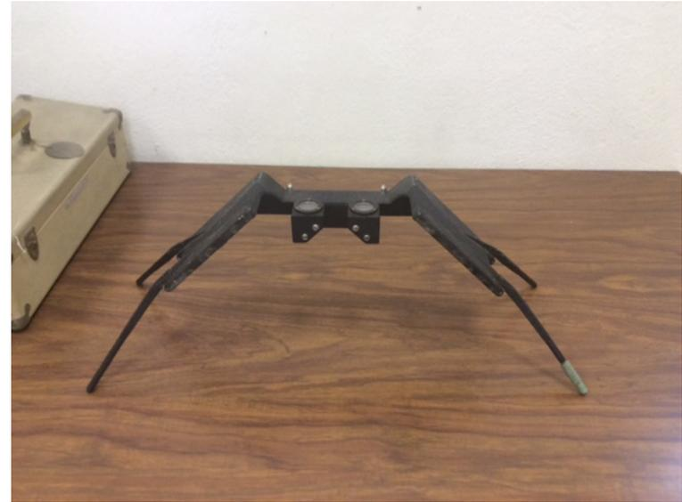
Figura 12. Lente binocular para observación de estereopares, empleado en el Centro Churubusco en la década de 1970, recuperado en abril de 2015 (Fuente: Fototeca CNCPC-INAH).
