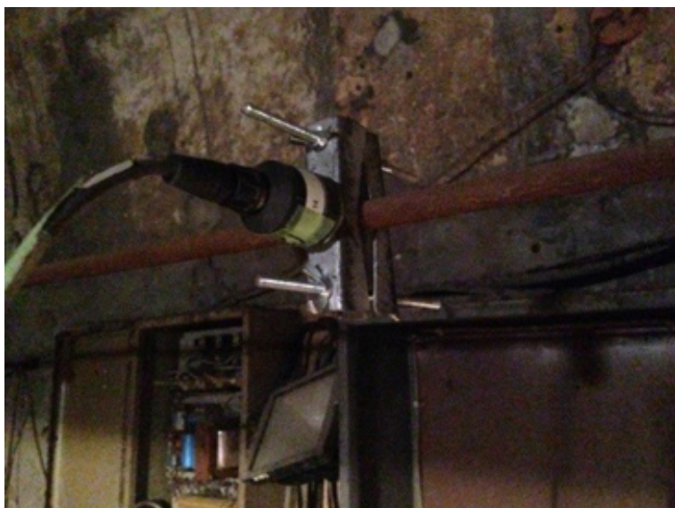
Figura 9. Montaje de acelerómetros en tensores. a) Tensor del siglo XIII. b) Tensor del siglo XX.
