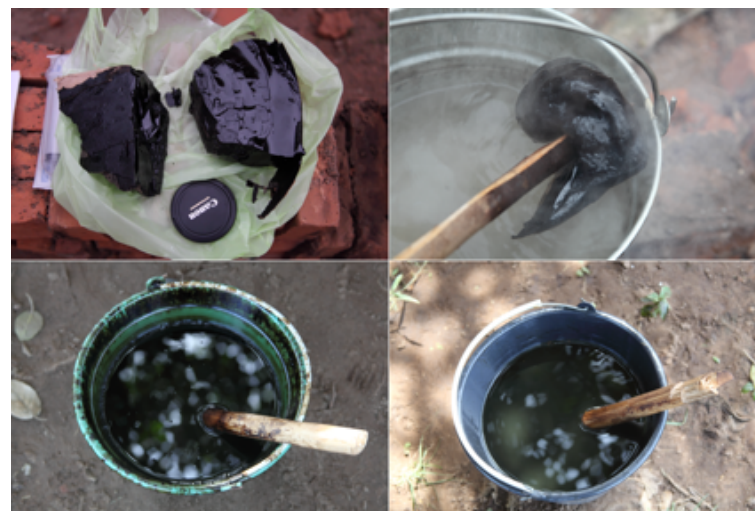
Figura 3. Preparación del extracto acuoso de bitumen y bitumen disuelto en aceite de linaza, Annick Daneels y Yuko Kita, 2013.
