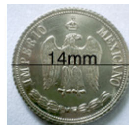
Figura 1. Tamaño y apariencia de las monedas probeta
