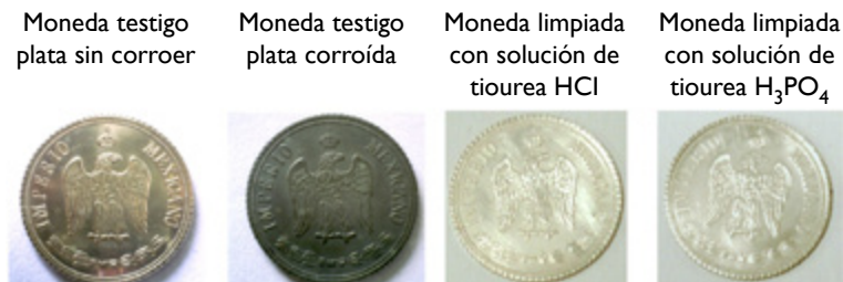
Figura 4. Vista de las monedas testigo: limpia, sin corroer y corroída, y ejemplos de las monedas corroídas artificialmente y después limpiadas con soluciones de tiourea HCl y tiourea H_3PO_4
