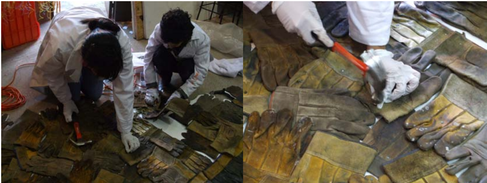
Figura 12. Colocación de los guantes sobre los nuevos paneles.
