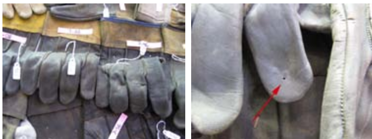
Figura 2(izquierda). Zona con guantes deformados.
