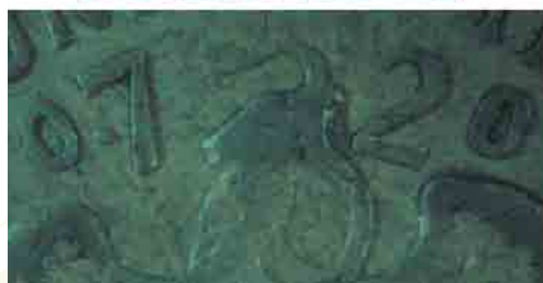
Superficie de plata limpiada con tiourea y ácido fosfórico
