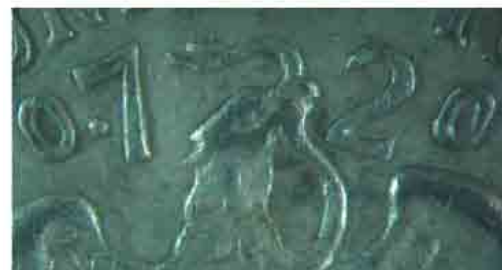
Superficie de plata limpiada con solución comercial de tiourea y ácido clorhídrico
