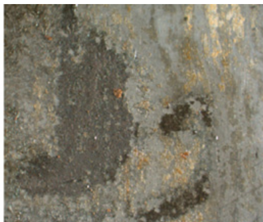
◀ Figuras 9 y 10. Fotografías de microscopio estereoscópico a 10X. (Izquierda) Muestra patrón, sin limpieza y (derecha) limpieza realizada con ácido fítico al 25% en agua. Fotografía de Fabiana González Portoni, 2011
