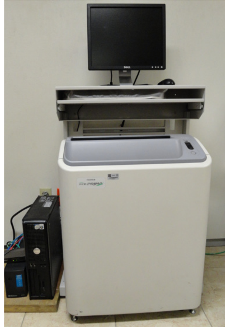
Figura 1. Equipo de radiología computarizada (FCR Prima de Fujifilm)
