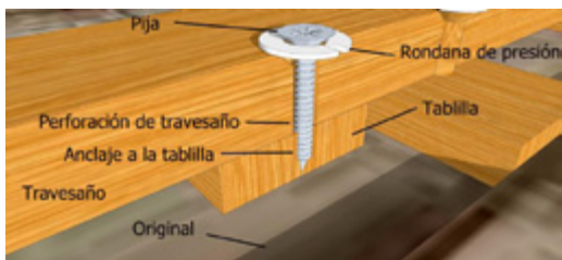
▼ Figura 22. Sistema empleado en la restauración de la tabla Cristo cargando la cruz ayudado por Simón Cirineo
