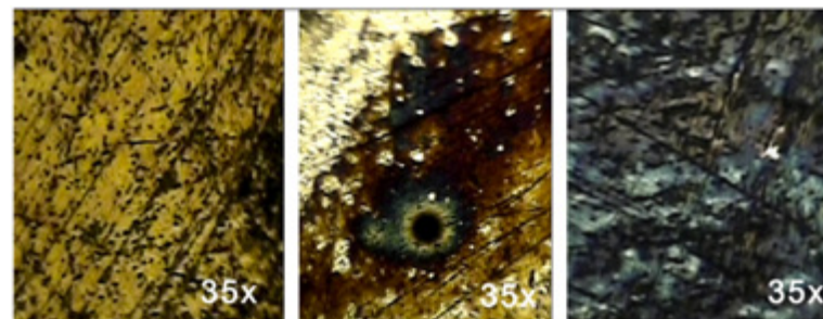
Figura 5. Detalles de la superficie y cambio de color. En todas las imágenes las líneas de pulido son claramente visibles: se acentuaron mediante la limpieza química, incrementando la rugosidad de la superficie. La diferencia de color puede indicar la etapa y el grosor de la corrosión; desde la izquierda: amarillamiento, manchas café y violeta iridiscente y oscurecimiento total
