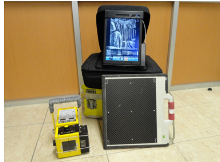
Figura 2. Equipo de radiología digital, chasis digital y generador de rayos X (Generador Mini X-Ray 80/15+; equipo de radiología Digital Slate de Cuattro y chasis digital Samsung)
