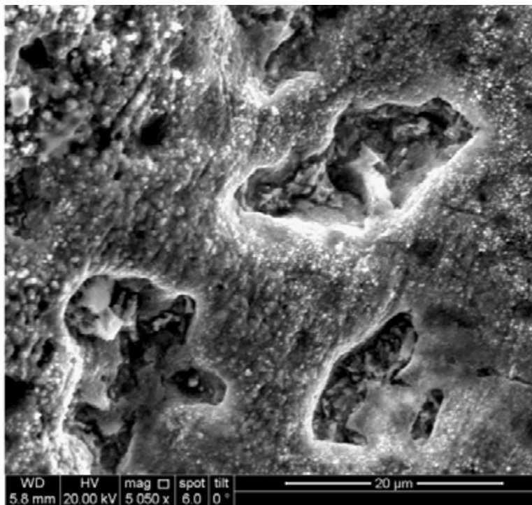
Figura 13. Imágenes de MEB del desarrollo de productos de corrosión, presumiblemente sulfuro de plata, en la orilla de una moneda limpiada con solución de tiourea H_3PO_4 después del envejecimiento de 240 horas.
