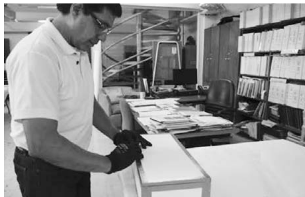
Figura 2 Paredes del embalaje unidas con cinta de vinilo autoadherible para ductos Fotografía © Joselyn Pompa García
