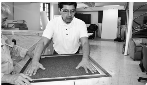
Figura 11 En la boca de la caja, a manera de empaque, se colocó cinta de neopreno de ¾" Fotografía © Joselyn Pompa García
