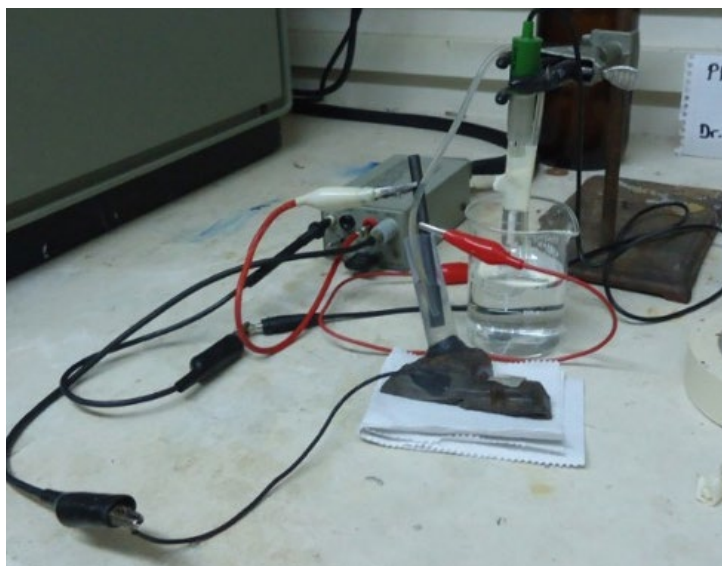
Fig. 4. Monitoreo de potencial de corrosión en piezas metálicas sumergidas y recuperadas del medio marino y esquema de aleaciones de bronce con pátinas en atmósfera marina, el diagrama muestra el arreglo experimental para la adquisición de datos. Autor: autoría propia.
