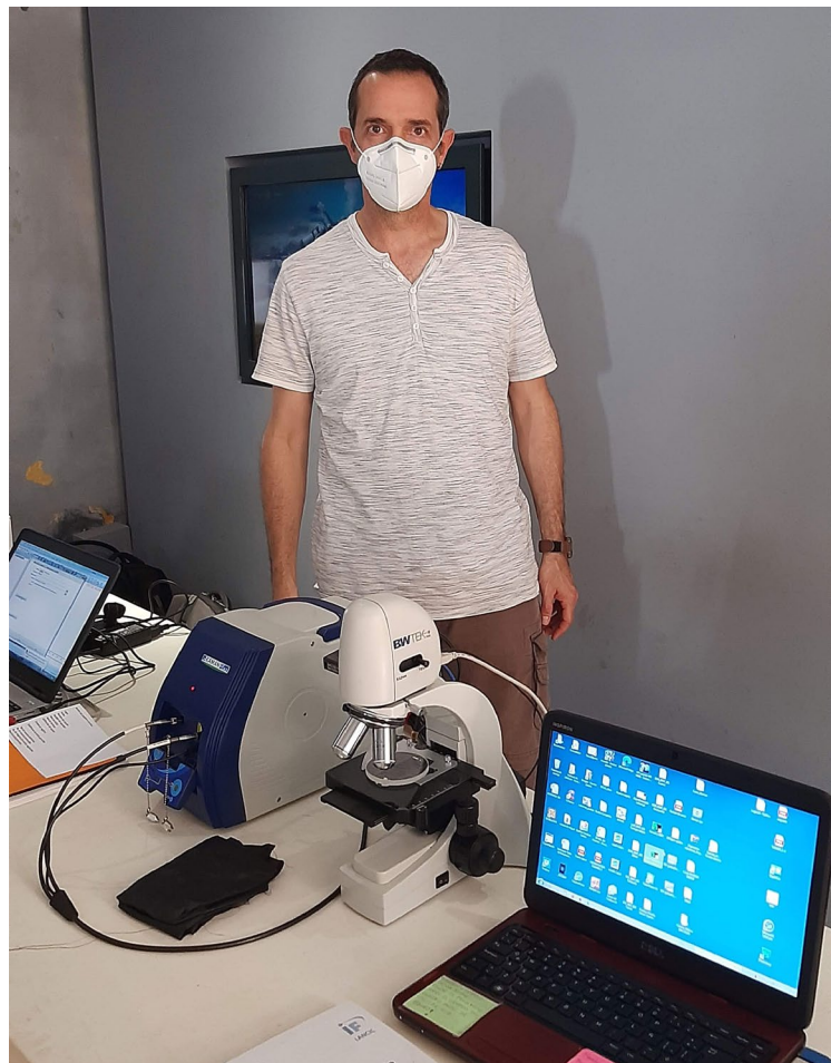
Figura 2. Equipo portátil para análisis mediante espectroscopía Raman, instalado en el Museo de Arqueología Subacuática (MARSUB).
