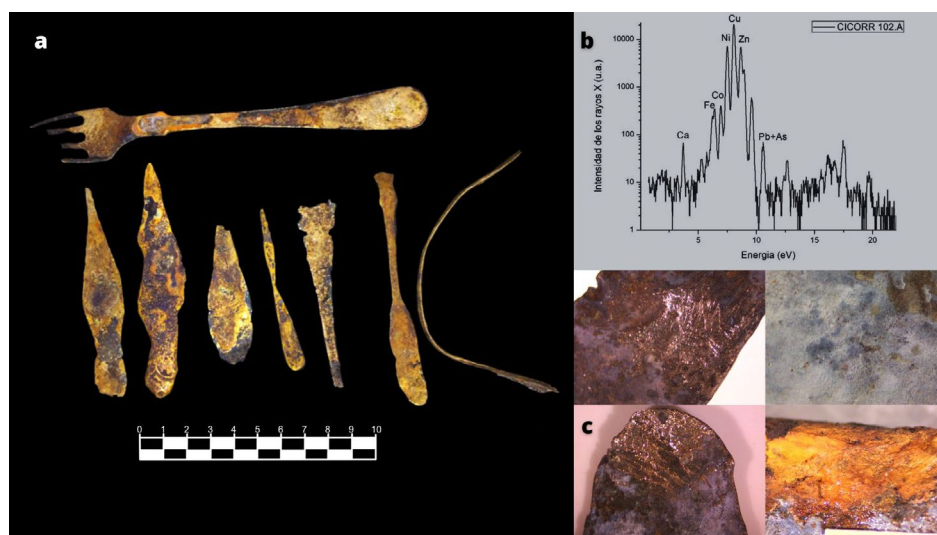
Fig. 4. a. Conjunto de ocho cubiertos de latón procedentes del pecio Vapor La Unión (1861), b. Tabla de análisis elemental obtenido mediante FRX en una pieza de la cubertería, c. Análisis microscópico de una pieza de la cubertería con presencia de productos de corrosión. © Archivo INAH, SAS, LANCIC-CICORR.
