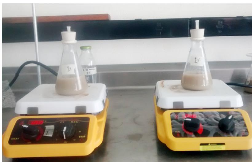
FIGURA 4. Proceso de hidratación del polvo de goma de nopal Opuntia ficus indica (Fotografía: Josué Israel Moreno Fraga, 2020).
