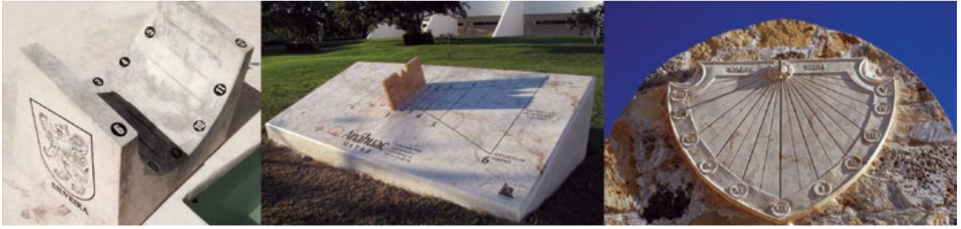
FIGURA 2. Izquierda: reloj ecuatorial semicilíndrico, el cual ostenta las armas del propietario (3:10 P.M.). Centro: cuadrante polar ubicado en el campus de la Universidad Anáhuac Mayab. Cuenta con curvas de declinación para equinoccios y solsticios y ecuación del tiempo (6:00 P.M.). Derecha: meridiana con hora solar local (7:50 A.M.). Diseños y construcción de Antonio Rodríguez Alcalá (Cortesía: Antonio Rodríguez Alcalá 2013).
