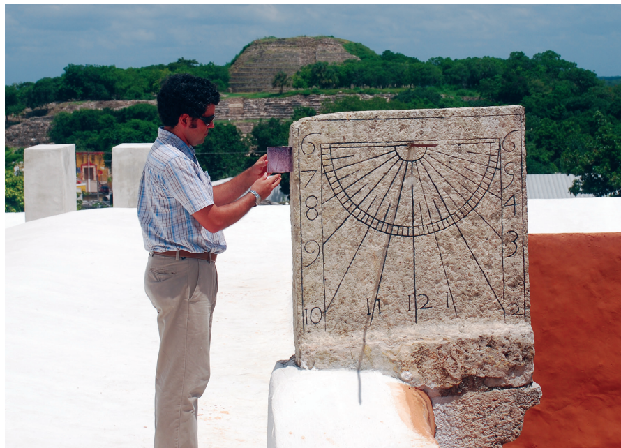
FIGURA 3. Cuadrante ecuatorial en el convento de san Antonio de Padua, Izamal. Demostración de la reclinación correcta que debería guardar el cuadrante ( 20^\circ 55' 57'' ), correspondiente a la latitud del lugar. Al fondo de la imagen se aprecia el Kinich Kakmó, vestigio piramidal mesoamericano (Fotografía: Antonio Rodríguez Alcalá, 2010).
