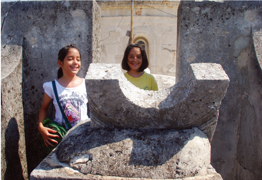
FIGURA 4. Reloj solar ecuatorial semicilíndrico en las bóvedas de la catedral de Mérida (ca. siglo XVII), el cual se encuentra correctamente orientado y reclinado. La hora que marca la pieza es 9:10 A.M. (Fotografía: Antonio Rodríguez Alcalá, 2010).
