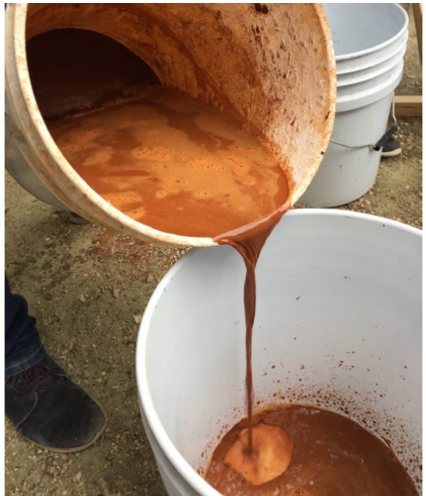
FIGURA 4. Decantación de tierra para extraer su arcilla después de que los limos y arenas se sedimentaron en el fondo del recipiente (Fotografía: Luis Fernando Guerrero Baca, 2018).
