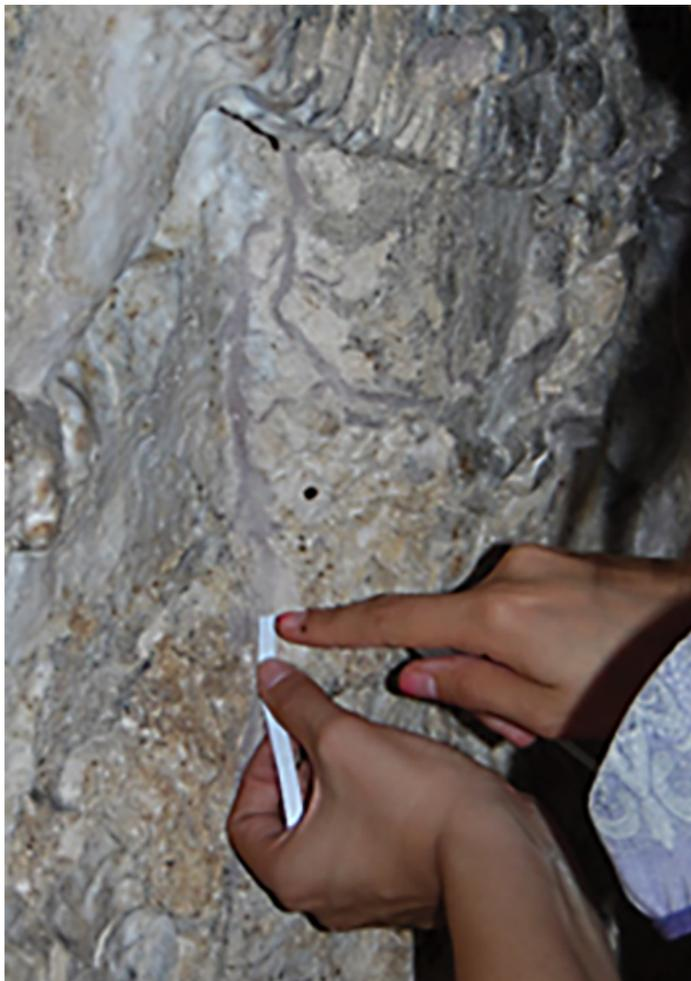
**Medición de salinidad en los muros**
