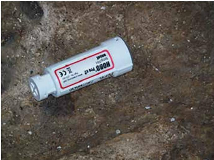
**Registro del tipo de Termohigrómetros empleados en la tumba para medir humedad y temperatura**
